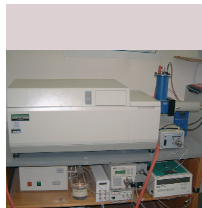
LC-CD zur Aufnahme von CD-Spektren von Verbindungen. Wird in Kombination mit computerchemischen Methoden zur Aufklärung der Absolutkonfiguration von chiralen Molekülen verwendet.
