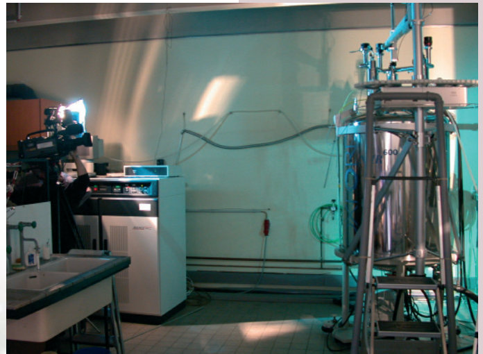
600 MHz-NMR zur Messung der Substanz-Spektren
